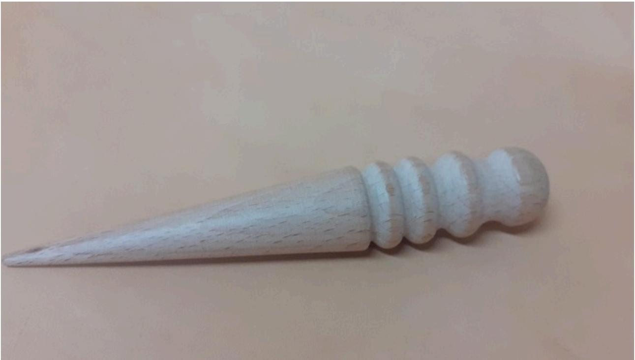
Piccolo strumento in legno, utile per stondare e rifinire i bordi del cuoio a taglio 'vivo'.
